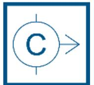
Entnahmemöglichkeit trocken, C-Anschluss
